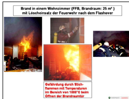
Bild 7: Brand in einem Wohnzimmer (FFB) mit Löscheinsatz der Feuerwehr nach dem Flashover
