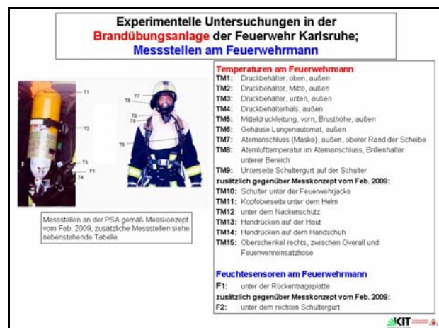
Bild 30: Messstellen am Feuerwehrmann
