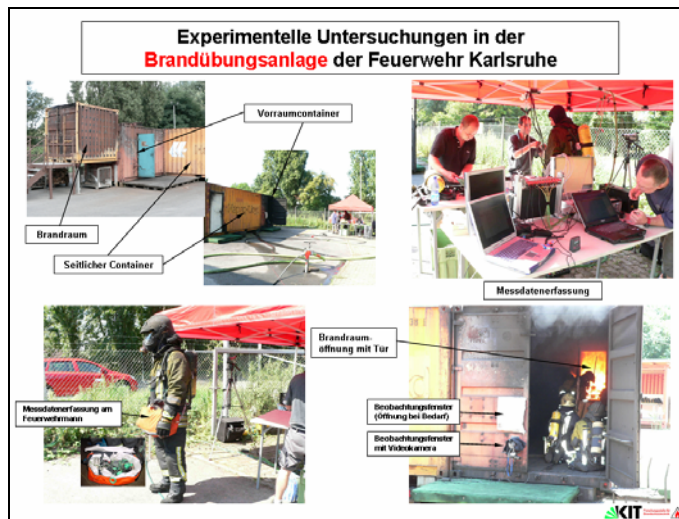
Bild 28: Holzbefeuerte Brandübungsanlage der Feuerwehr Karlsruhe Der Brandraumcontainer, kurz Brandraum genannt, wird zur Befeuern der Anlage mittels Holzpaletten verwendet. Dieser hat die Innenabmessungen: Länge= 2,4 m, Breite= 2,0 m und Höhe= 2,2 m.
