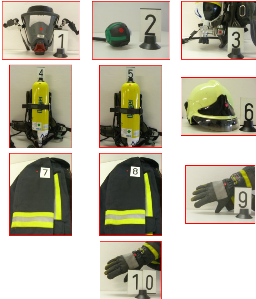
Bild 14: Messstellen an den Komponenten der PSA
