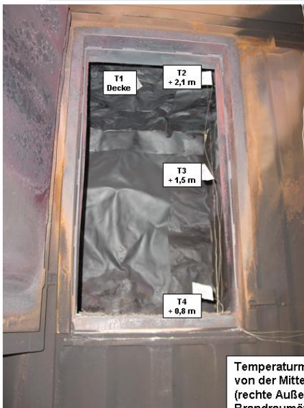
Bild A51: Temperaturmessstellen im Vorraumcontainer
