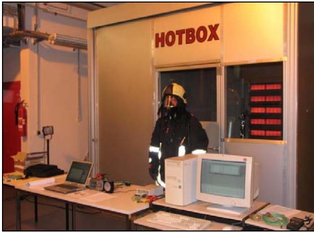
Bild 35: Hotbox mit Messplatz und Proband
