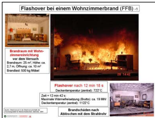
Bild 6: Flashover bei einem Wohnzimmerbrand (FFB)
