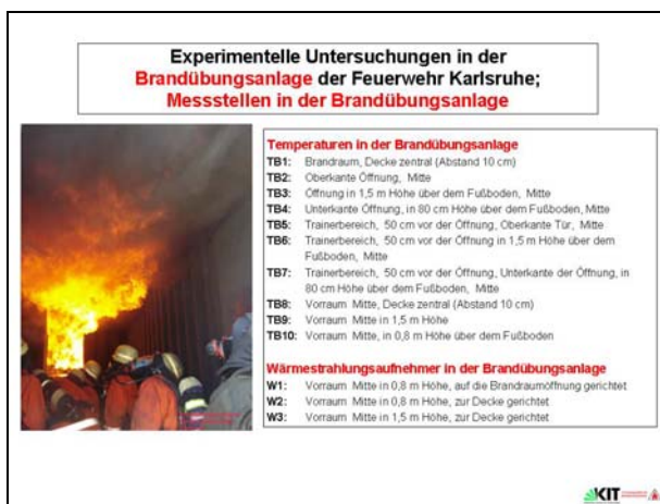
Bild 29: Messstellen in der Brandübungsanlage
