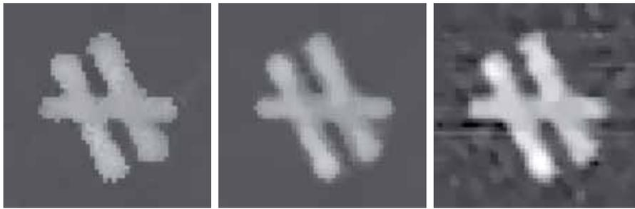
**Abbildung 7.4:** Ergebnis der freiheitsgradbeschränkten Regularisierung mit 202 Bildelementen des anisotropen Bildmodells (links) bzw. 16 Bildelementen des isotropen Bildmodells (Mitte) sowie der freiheitsgradunbeschränkten TV-Regularisierung (rechts).
