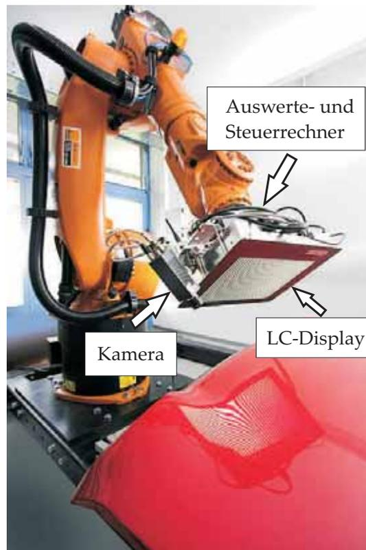
**Abbildung 3.1:** Deflektometrischer Messaufbau zur Vermessung spiegelnder Oberflächen. Die Positionierung durch einen Roboterarm ermöglicht auch die Vermessung großer und komplex geformter Prüfteile.
