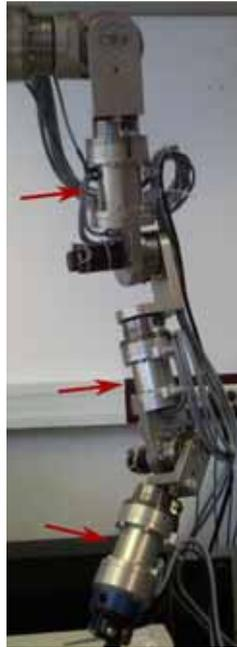
Abbildung 10.2: Verwendeter Manipulator mit 7 Freiheitsgraden.
