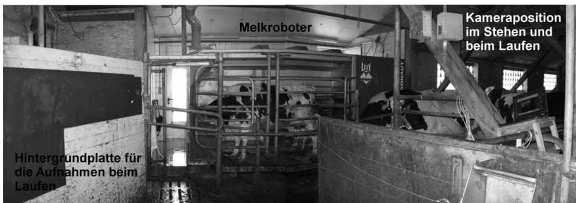
**Abbildung 34.2:** Messanordnung für Bildaufnahmen stehender Kühe im Melkroboter (hinten) und laufender Kühe vor einer Wand (links).
