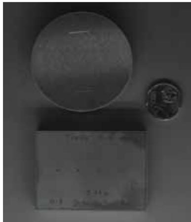
**Abbildung 15.2:** Oben: Prüfkörper 50 mm Durchmesser, Nuten mit Breiten 0.3 mm, 0.25 mm, 0.2 mm, 0.12 mm. Unten: Prüfkörper 55 mm × 40 mm, Bohrungen mit Durchmessern 0.8 mm, 0.6 mm, 0.4 mm, 0.2 mm.
