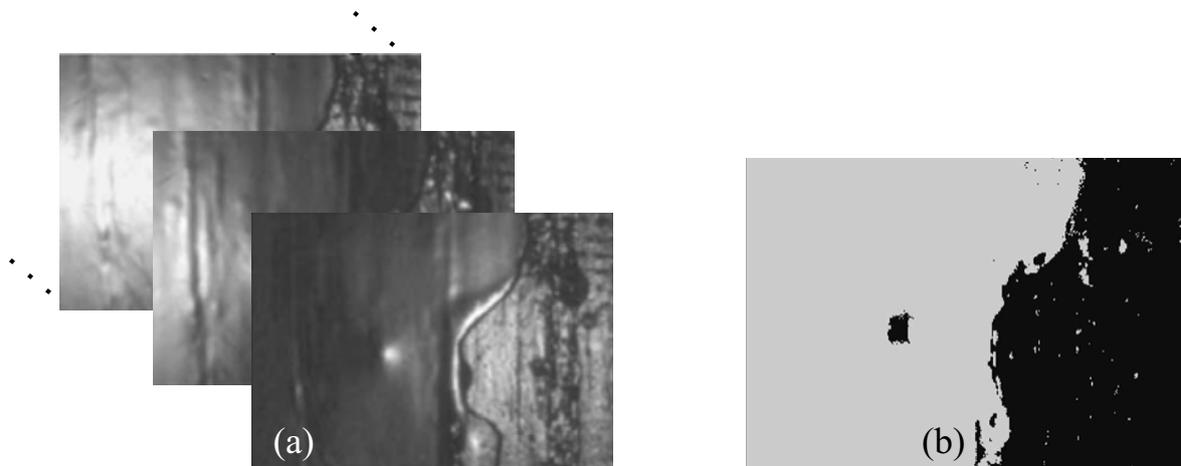
**Abbildung 28.3:** Segmentierung eines unvollständig lackierten Holzstücks: (a) Elevationsserie; (b) Segmentierungsergebnis basierend auf einem Reflexionsparameter des Modells (grau: lackiert; schwarz: nicht lackiert) [5].
