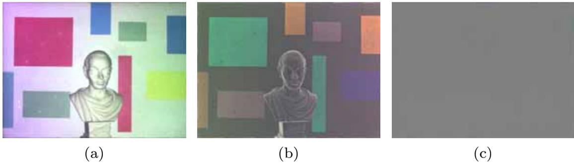
**Abbildung 27.2:** Ergebnisse der fotometrischen Kompensation. (a) Testszene mit homogener koaxialer Beleuchtung. (b) Inverses Beleuchtungsmuster, ermittelt mit Algorithmus (27.2) nach  $t = 5$  Iterationen. (c) Aufgenommenes Kamerabild bei Beleuchtung der Szene mit inversem Beleuchtungsmuster. Die fotometrische Erscheinung der Testszene ist unterdrückt.
