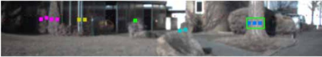
**Abbildung 9.1:** Scan in das Kamerabild referenziert. Das grüne Rechteck bezeichnet den Ausschnitt, welcher zur Berechnung der visuellen Signatur verwendet wird.
