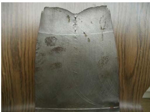
Bild 4: Zugprobe in Walzrichtung
