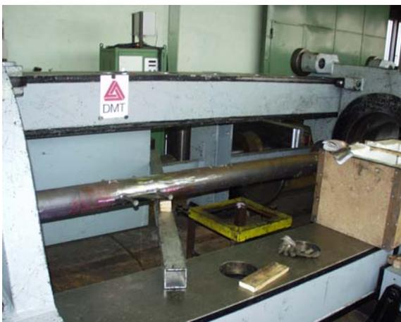
Bild 12 a: Probekörper in einer Zugprüfmaschine
