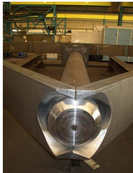
Bild 8: Anschluss Diagonale an Obergurtnoten
