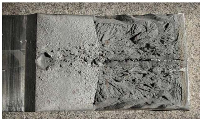
Bild 5: Bruchfläche einer CTOD-Probe
