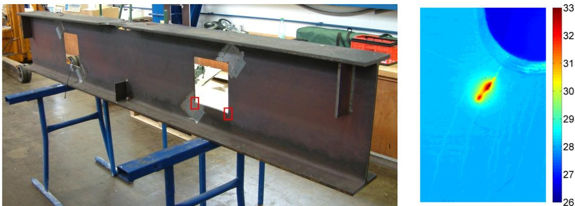
**Abbildung 2: links: 3,2 m langer Walzträger (IPE 500); rechts: Maximal erreichte Temperaturen während eines Ultraschall-Bursts [°C]**
