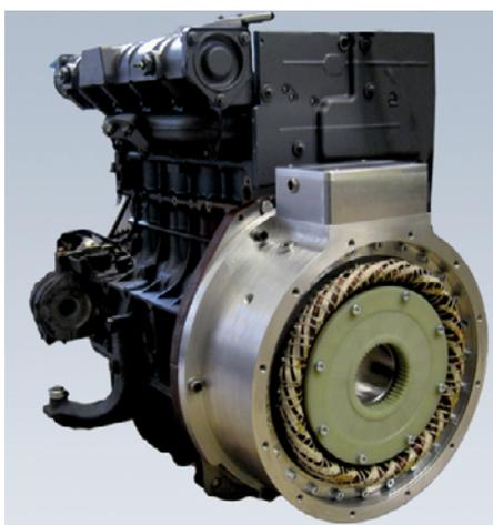
Abb. 13: HEINZMANN E-Maschine mit verteilter Wicklung als Parallelhybrid mit DEUTZ Dieselmotor
