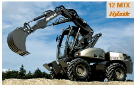
Abb. 2: Multifunktionaler Bagger MECALAC, ausgerüstet mit parallelem diesel-elektrischem Hybrid von Heinzmann
