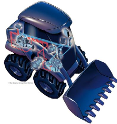
Abbildung 2 – Kompaktlader, die Beispielplattform für den Hydraulischen Power Boost (HPB)
