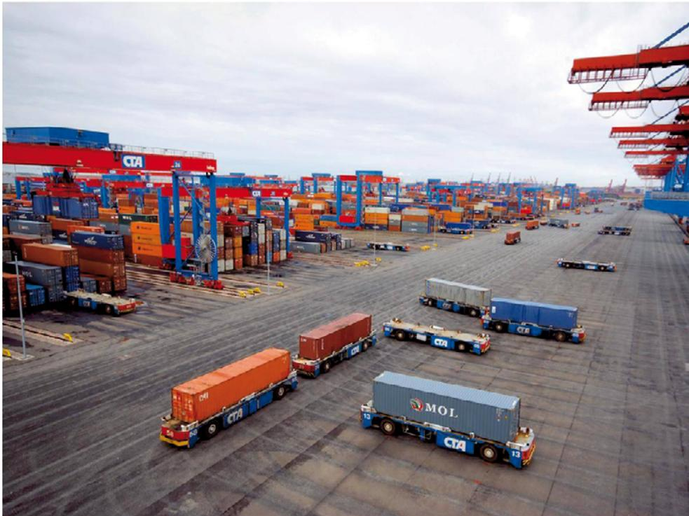
Abb. 1: Modernes Container Terminal mit Automated Guided Vehicles (AGV)
