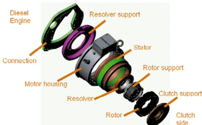
Abb. 12: Mechanischer Aufbau der E-Maschine für Parallelhybrid, vorbereitet für Montage auf Kurbelwelle des Dieselmotors
