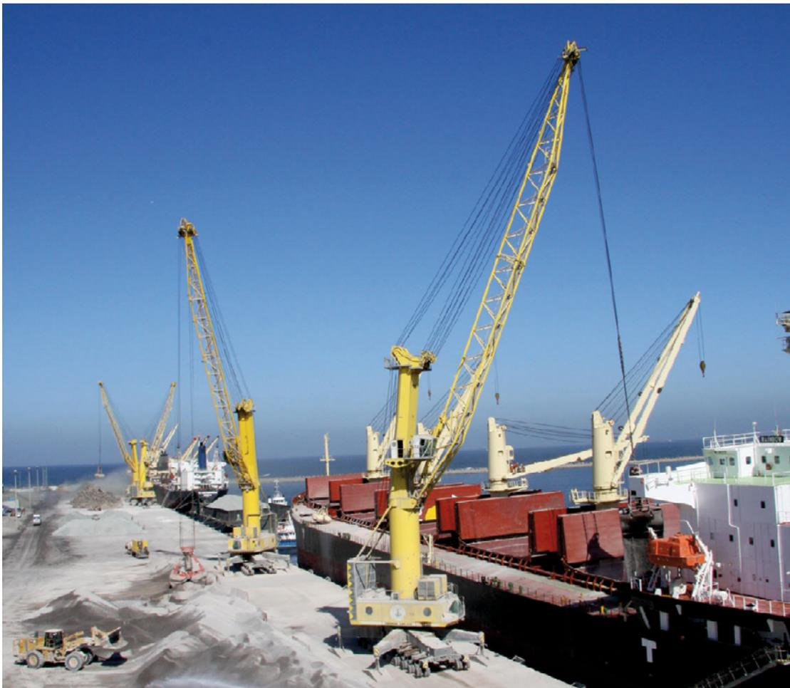
Abbildung 1: Greiferumschlag mit Liebherr Hafenmobilkranen
