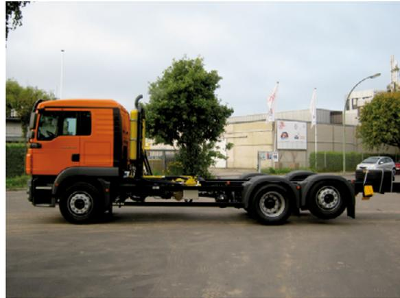
Abb. 10: autarker Hydraulikhybrid auf MAN TGM [4]
