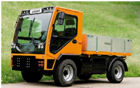
Abb. 1: Mehrzweck-Kommunalfahrzeug LADOG, ausgerüstet mit parallelem diesel-elektrischem Hybridantrieb von Heinzmann
