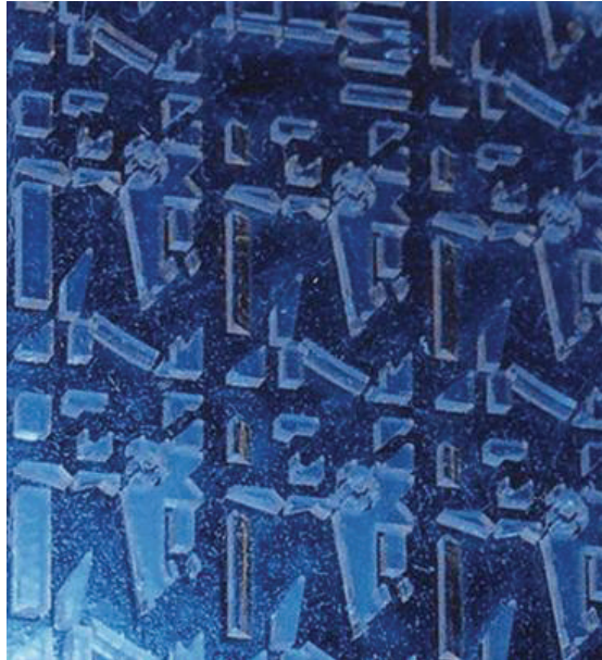
Bild 4-8: Abgeformte mikrooptische Bank, abgeformt in PMMA. Detailaufnahme.
