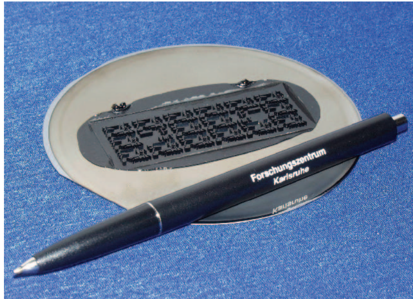
Bild 4-7: Erst die Abformung auf Siliziumwafern mit geringem thermischen Ausdehnungskoeffizienten erlauben den Einsatz der MOB aus Kunststoff in der Praxis. Die Abformung erfolgte in Polycarbonat (schwarz)
