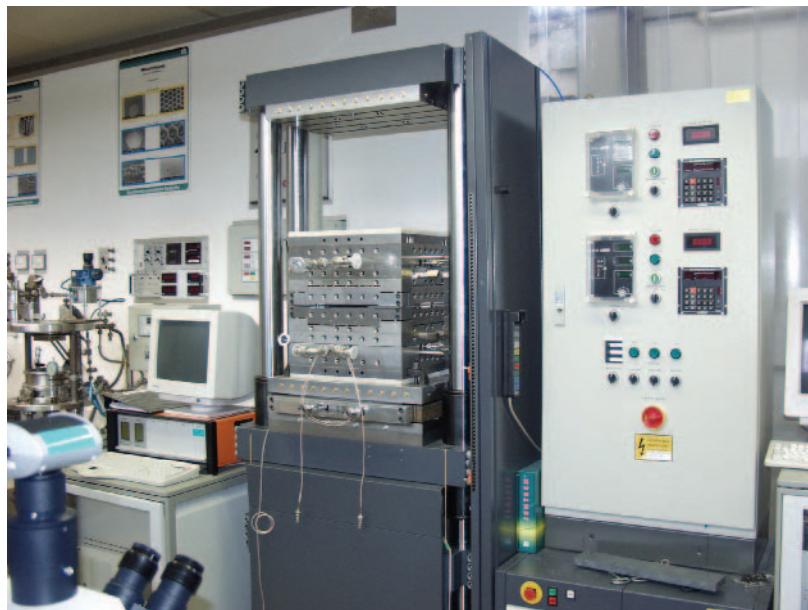
Bild 4-4: Ein parallel entwickeltes Forschungswerkzeug für justierte beidseitige Abformung mit integrierten Auswerfern. Dieses Werkzeug kann durch den modularen Aufbau der neuen Prägemaschine auch in die Wickert WMP1000 eingebaut werden.
