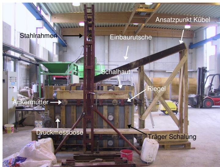
**Bild 3.7:** *Rutsche für den Einbau der frischen Betone bzw. Mörtel in das verwendete Modellschalungssystem – Anordnung zusammen mit Schalung und Stahlrahmen*
