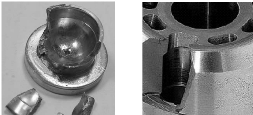
Abb. 3.15.: Links: Gewaltbruch eines Kolbengleitschuhs durch Überlast Rechts: Schwingbruch der Zylinderwand
