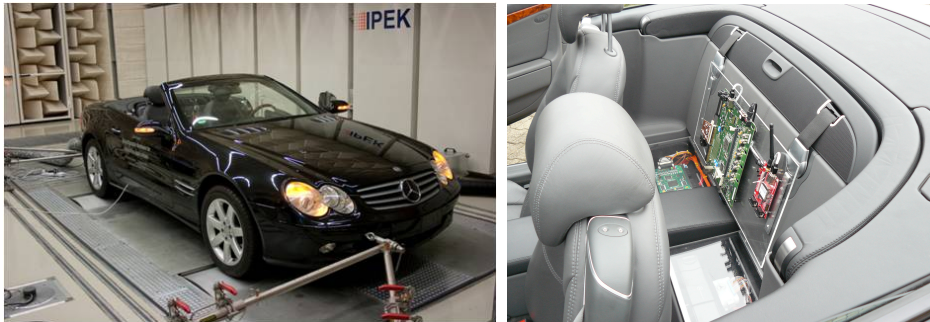
Abbildung 5.25.: Einbau des C2X-Kommunikationssystems in das Versuchsfahrzeug
