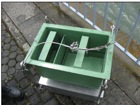
Abbildung 4-7: Sedimentfalle der LUBW
