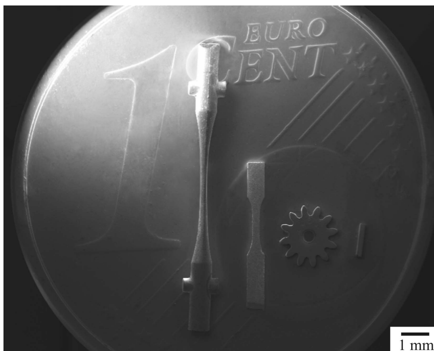
Abbildung 1.1: Mikroproben (v. l.): Torsionsprobe, Zugprobe, Zahnrad, Biegeprobe.
