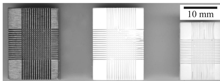
Abbildung 2.7: Von links: Mikrogefrästes Urmodell des Probenarrays aus Messing, entformter Grünling und gesintertes Fertigteil aus ZrO_2 nach [Mül07].
