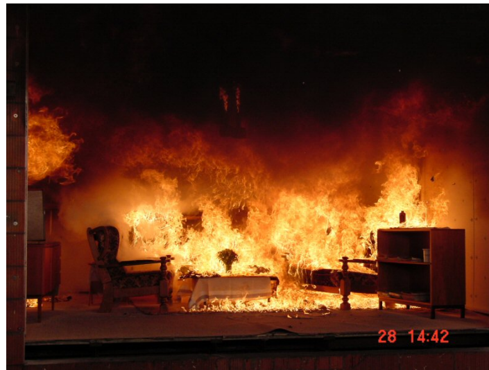
Bild 5-5 Brandraum nach erfolgreichem Flashover [FFB]
