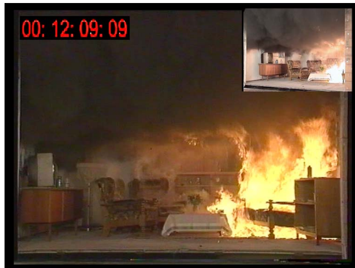
Bild 5-3 Brandraum ca. 12 Minuten nach der Zündung [FFB]
