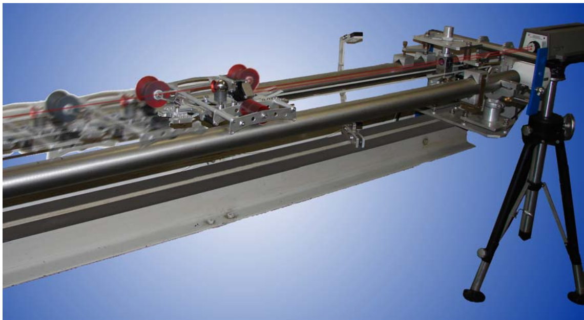
Abb. 3-3: Hochgeschwindigkeitsmessbahn, Betriebsmodus „kinematisch“
