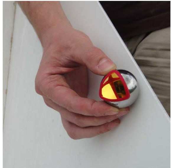
Abb. 1-2: Messung mit dem Corner-Cube-Reflektor (CCR).
