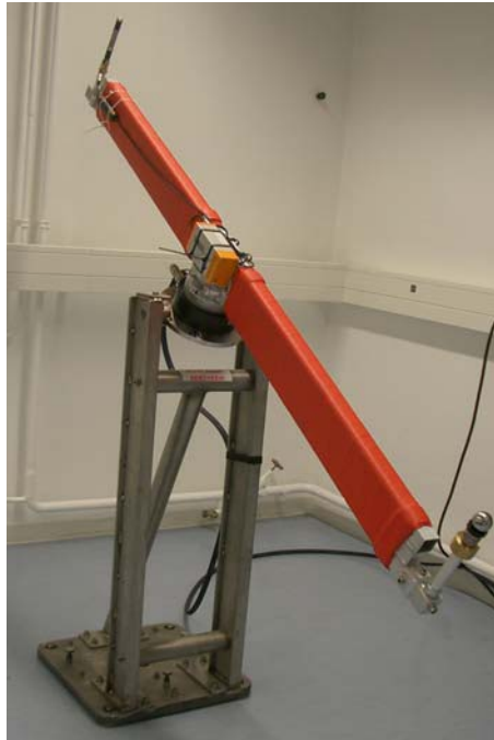
Abb. 3-1: Ti4CalibS des GIK, mit Komponenten des iGPS (oberes Ende und Mitte des Dreharms) und CCR (unteres Ende, optional, für simultane Vergleichsmessungen mit dem Lasertracker)
