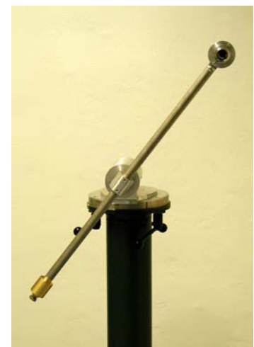
Abb. 3-8: GIK-Eigenkonstruktion der Ballbar
