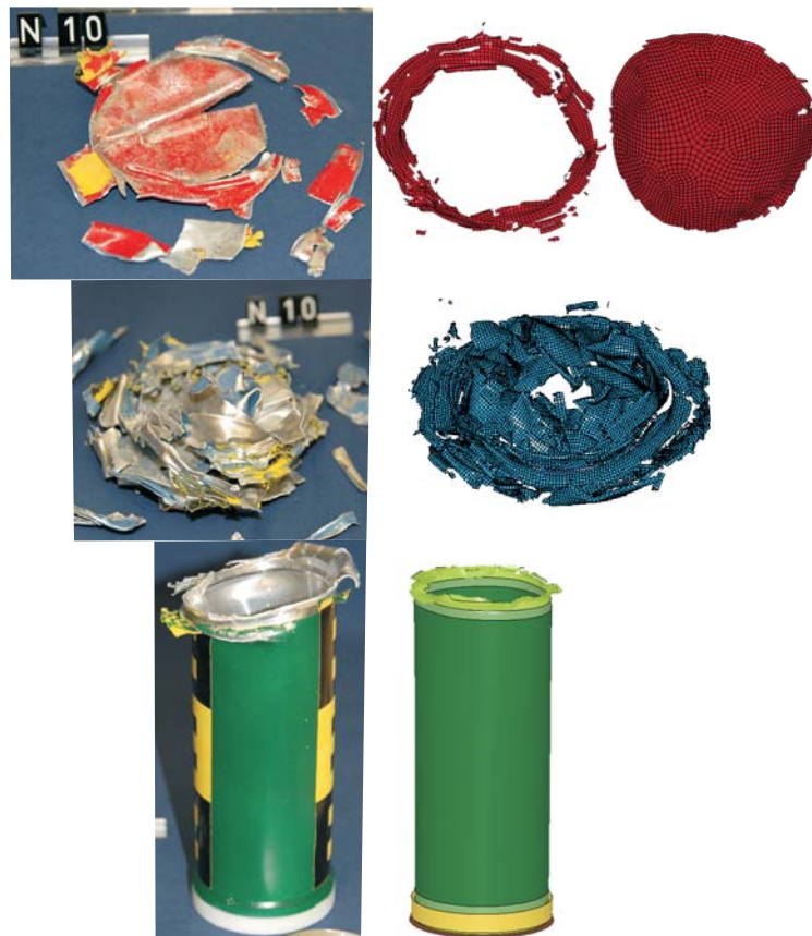
Abbildung 8.2: Vergleich der Reststücke aus Versuch und numerischer Berechnung für Versuch K8
