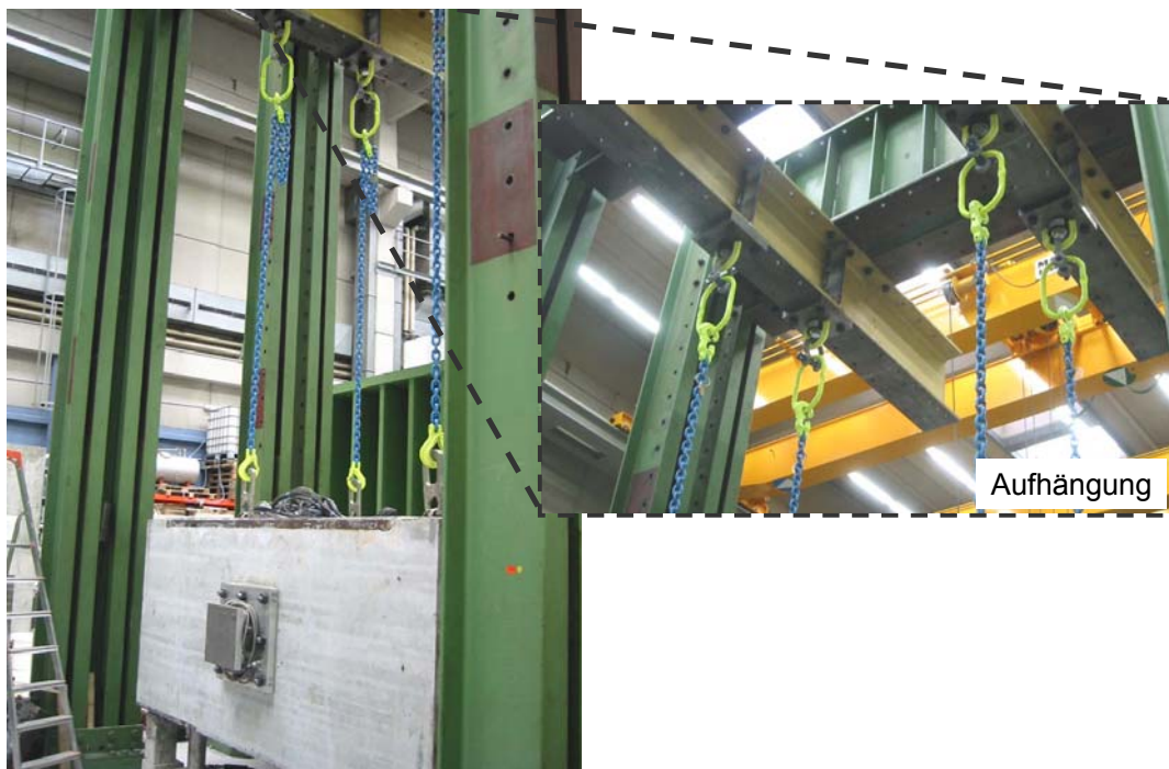
Abbildung 3.3: Versuchsaufbau „großes Pendel“
