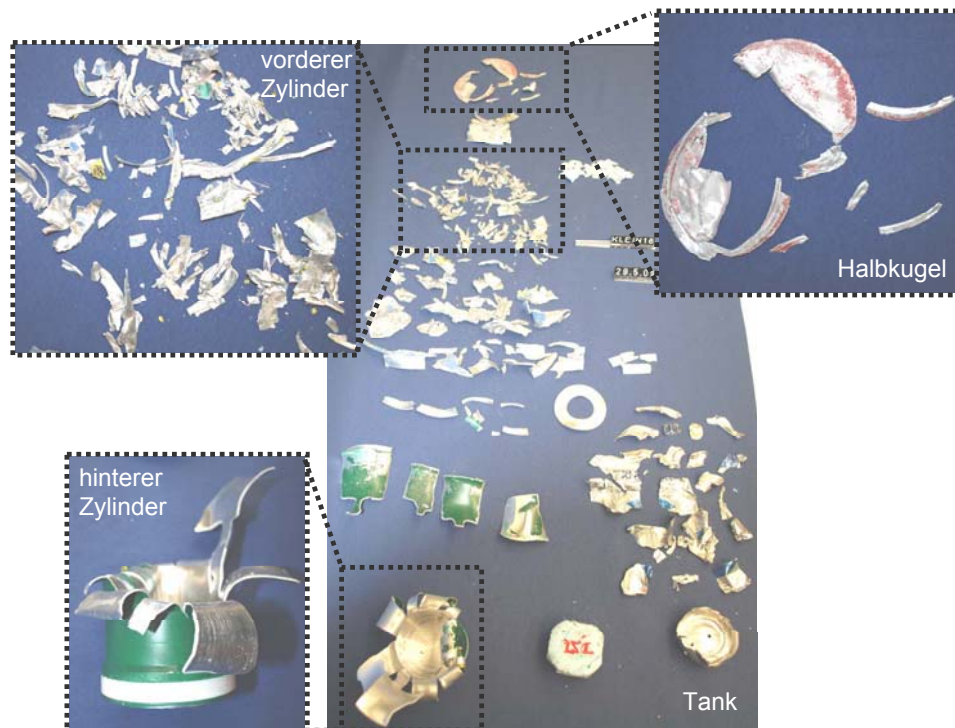
Abbildung 5.17: Fragmente nach dem Aufprall, Versuch K18
