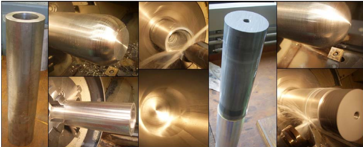
Abbildung 3.20: Einzelschritte der Fertigung des vorderen Projektileils
