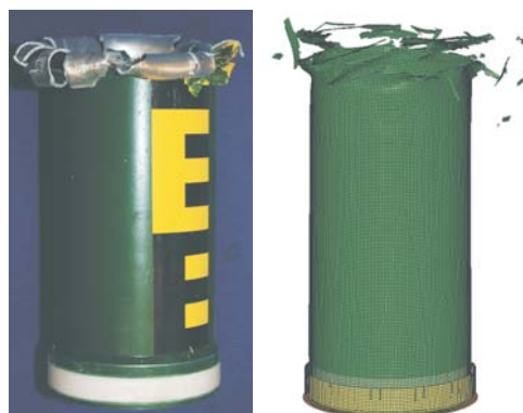
Abbildung 8.7: Vergleich der Reststücke des hinteren Zylinders aus Versuch und numerischer Berechnung für Versuch K23
