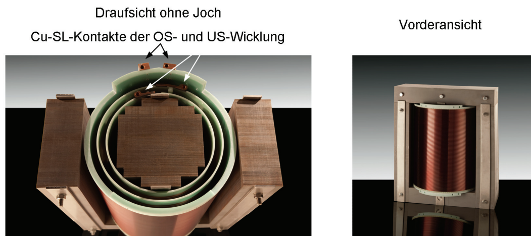
Abb. 5.5: Links: Draufsicht der OS-Wicklung (eine Lage) und der US-Wicklung (zwei Lagen) auf dem Eisenkern ohne Joch. Es sind die Kupfer-SL-Kontakte der Wicklungen zu sehen. Rechts: Vorderansicht des gesamten Transformators.
