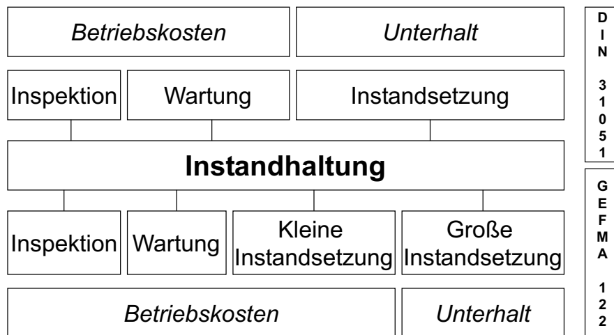
Abbildung 3.1: Gegenüberstellung der Struktur der Instandhaltung nach DIN 31051 und GEFMA 122, Quelle: in Anlehnung an GEFMA 122 [57]
