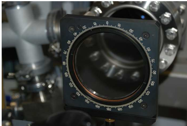
Abbildung 5.2.3: Ein THz-Polarisationsgitter mit 15 \mu\text{m} Drahtdurchmesser und 60 \mu\text{m} Drahtabstand. Die Transmission des Filters für den Vektor des elektrischen Feldes senkrecht zum Gitter im THz-Bereich ist 1.
