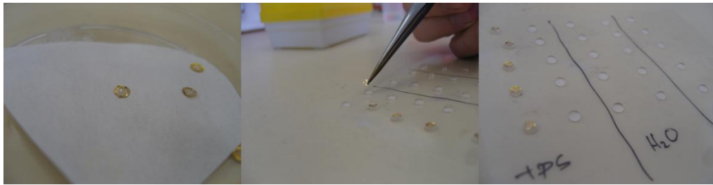
Abbildung 33: Probenpräparation zur TEM. Deutlich erkennbar ist das Handling der Probenhalter.
