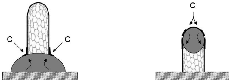
Abb. 1.6: Schematische Darstellung der Wachstumsszenarien: (a) Root-Growth-Prozess, (b) Tip-Growth-Prozess (nach [42]).
