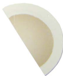
Abb. 3.29: Die Abbildung zeigt ein gefiltertes Buckypaper (100 μl) noch auf dem Filter. Im Zentrum des kreisförmigen Filters ist das Buckypaper deutlich heller und damit dünner als am Rand.
