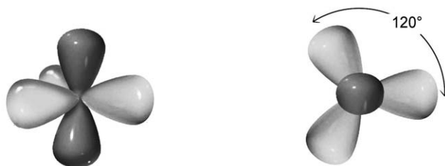
Abb. 1.22: Seiten- und Aufsicht eines sp^2 -hybridisierten Atoms. Die hell dargestellten Orbitale liegen in einer Ebene und sind für die Bindung entlang der CNT-Seitenwände zuständig, während die dunkelgrau dargestellten Orbitale senkrecht zur Ebene für van-der-Waals-Wechselwirkungen mit anderen Molekülen verantwortlich sind [86].
