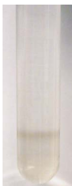
Abb. 3.11: Separationsergebnis einer mittels High-Shear-Mixing suspendierten Suspension. Die schwach konzentrierte Suspension zeigt keine farbigen Banden, das gesamte Material sackt auf die Stop-Layer-Grenze.
