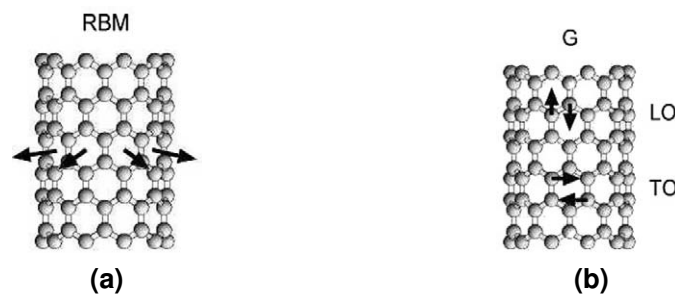
Abb. 1.25: Schematische Darstellung (a) der radialen (RBM) und (b) der tangentialen Schwingungsmoden (G) nach [93].
