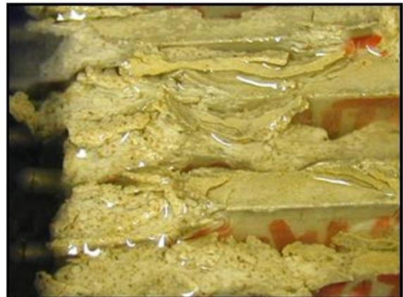
Abb. 8: Zerstörte Mörtelprismen infolge einer Thaumasitbildung (Quelle: VDZ Lipus)
