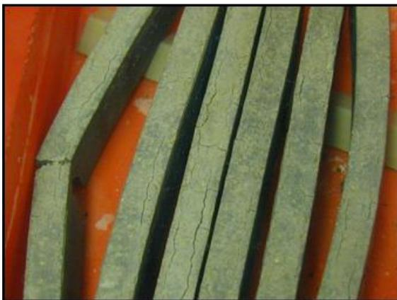
Abb. 7: Zerstörte Mörtelprismen infolge einer Ettringitbildung (Quelle: VDZ Lipus)
