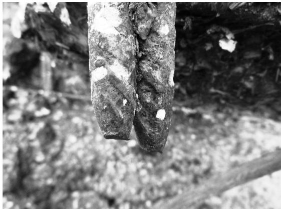
Abb. 5: Versagen der inneren Bewehrung an der Einspannstelle
