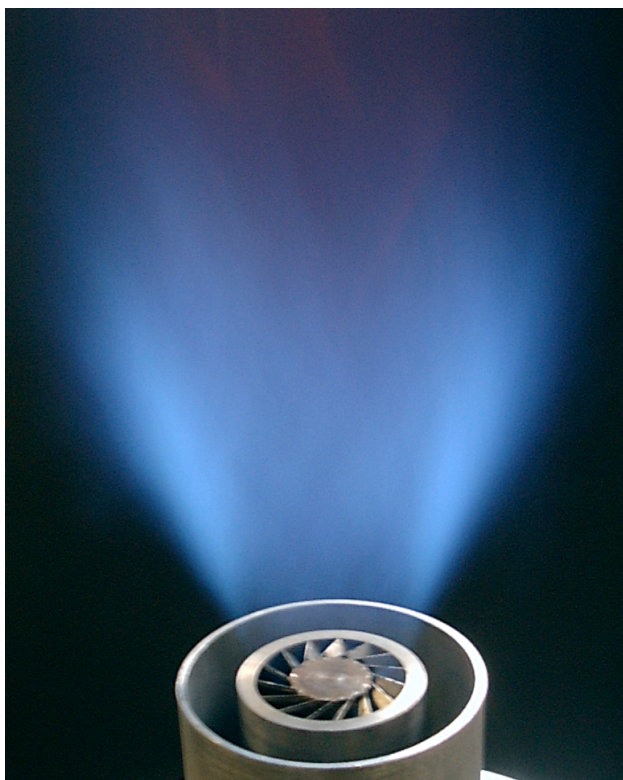
Abb. 6.8: Beispiel einer voll-vorgemischten, turbulenten Erdgas-Luft-Drallflamme
