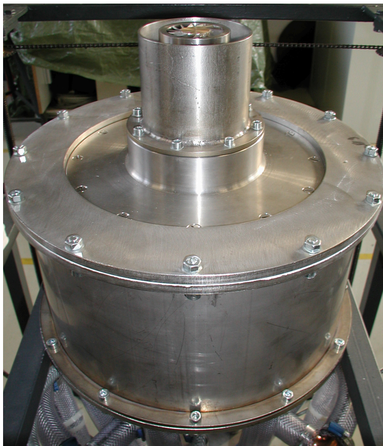
Abb. 6.6: Versuchsträger doppelt-konzentrischer Drallbrenner
