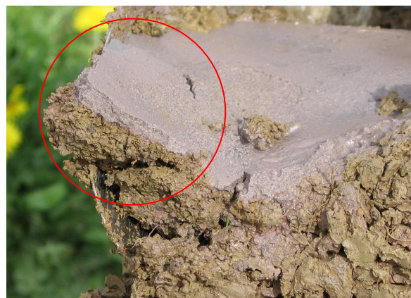
Abb. 6-1 Bodenprobe B bei BV #21 nach Abschluss der Bohrarbeiten mit Feststoffablagerung
