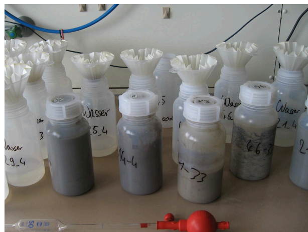
Abb. 7-2 Filterung der 200 ml Überstandswassers
