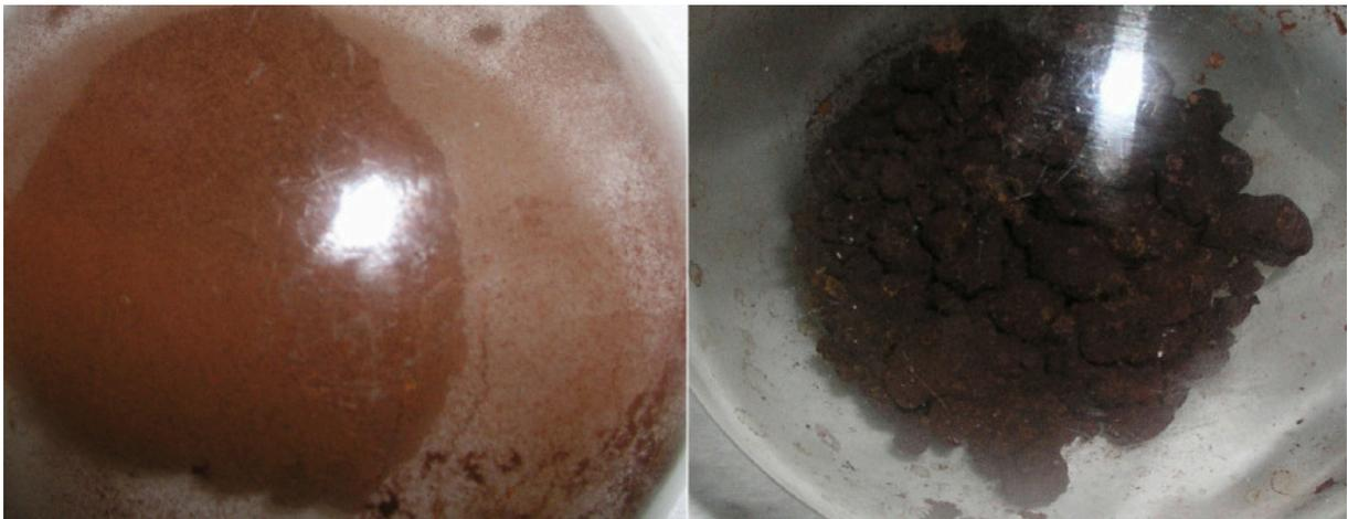
**Abbildung 76:** Fotos eines Rundkolbens mit SBA-15: Links: nach 25 Beschickungen mit GeBr; Rechts: nach 45 Beschickungen mit GeBr.
