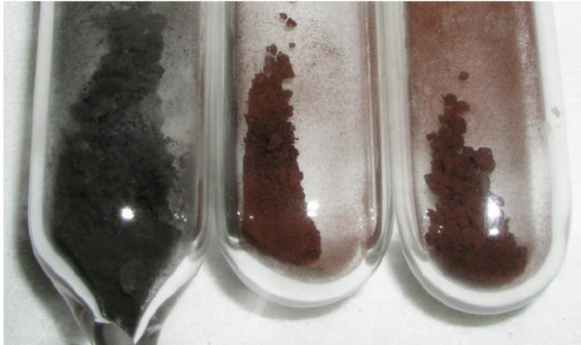
**Abbildung 77:** Fotos von GeBr/SBA-15 Proben in Quarzampullen: Links: nach Tempern auf 600°C; Rechts: vor dem Tempern (45 mal beschickt); Mitte: vor dem Tempern (35 mal beschickt).
