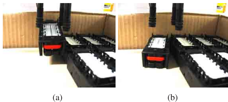
Abb. 4.3.: Objektverschiebung als Folge von Ungenauigkeiten: (a) Ungenaues Fügen resultiert in (b) Objektverschiebungen nach dem Loslassen
