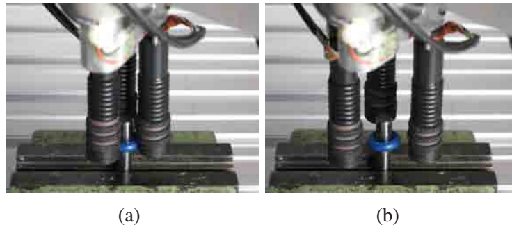
Abb. 4.33.: Sensorlose Loslassstrategie des montierten O-Rings: (a) Ausgangsposition nach dem Fügen des O-Rings auf den Stift, (b) Sensorloses Loslassen des O-Rings
