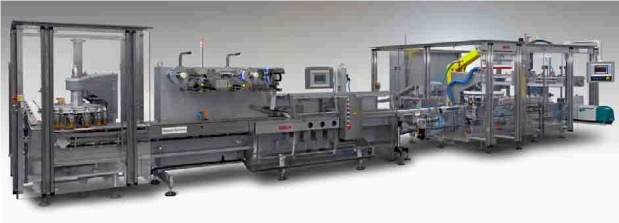
Abb. 1.1.: Vollautomatische Riegelverpackungslinie, Sigpack Systems (2010)
