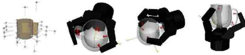
Abb. 3.9.: Generierung von Griffkandidaten basierend auf Formprimitiven nach Miller u. a. (2003)
