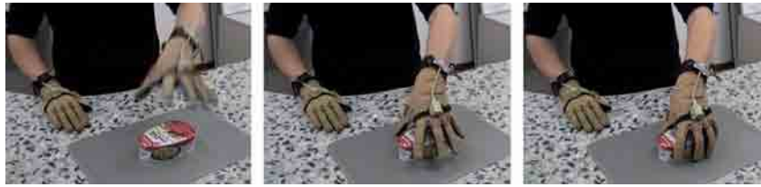
Abb. 3.11.: Vormachen von Greifbewegungen mit einem Datenhandschuh nach Jäkel u. a. (2010)
