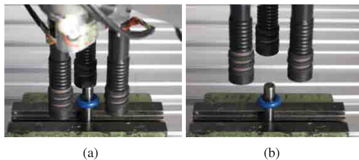
Abb. 4.34.: Sensorlose Abrückstrategie vom montierten O-Ring: (a) Ausgangsposition nach dem Loslassen des O-Rings, (b) Sensorlose Bewegung zur Abrückposition oberhalb des Stiftes
