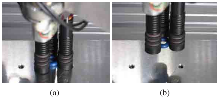
Abb. 4.30.: Sensorlose Abrückstrategie mit gegriffenem O-Ring: (a) Gegriffenes Objekt, (b) Sensorlose Bewegung auf die Abrückposition
