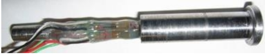
Abb. 3.8.: Dehnungsmessstreifen am Finger des 3-Finger-Stern-Greifers
