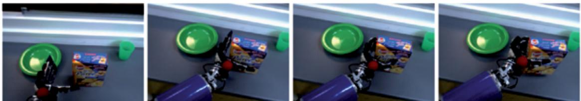
Abbildung 6.9: Die interne Sicht des Roboters ARMAR-III während des Greifens einer Schachtel.
