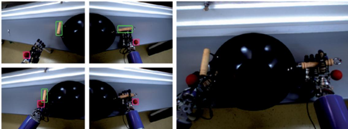
Abbildung 6.14: Der Wok wird simultan mit beiden Händen gegriffen, wobei die Hand über den Marker lokalisiert wird (rot) und über die Lage der Griffe (grün markiert) die Greifpositionen ermittelt werden. Die Zielposen sind relativ zum Objekt definiert und wurden über Nullkraftregelung eingelernt.
