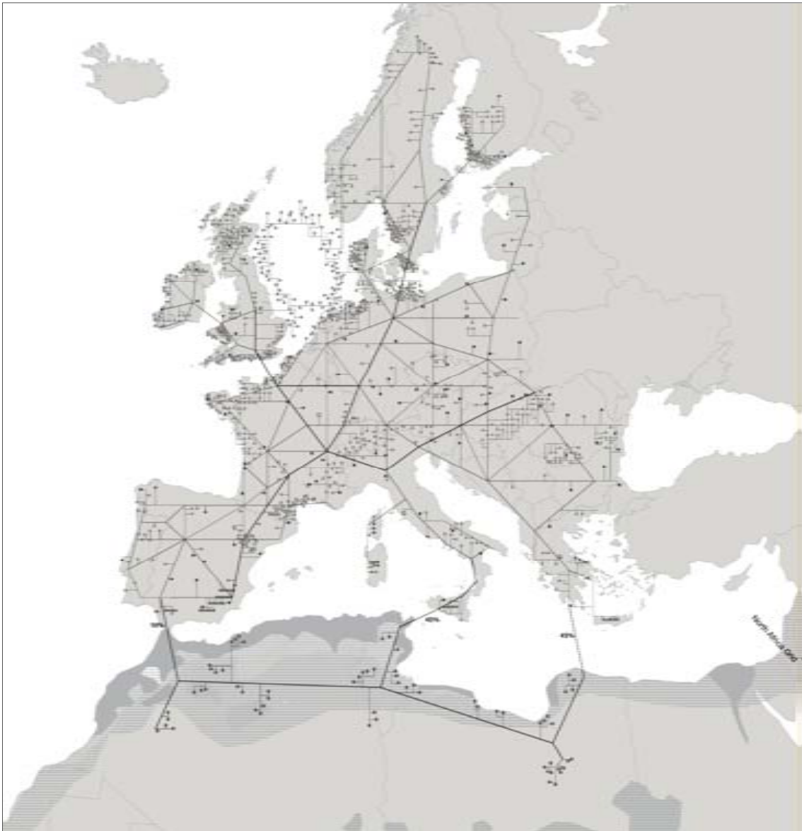
Abbildung 78 Struktur eines vorgeschlagenen „EU- Energy Grid“ zur Integration verschiedener Erneuerbarer Energien in Europa und Nordafrika (Quelle: ECF (2010), S. 176 f.)
