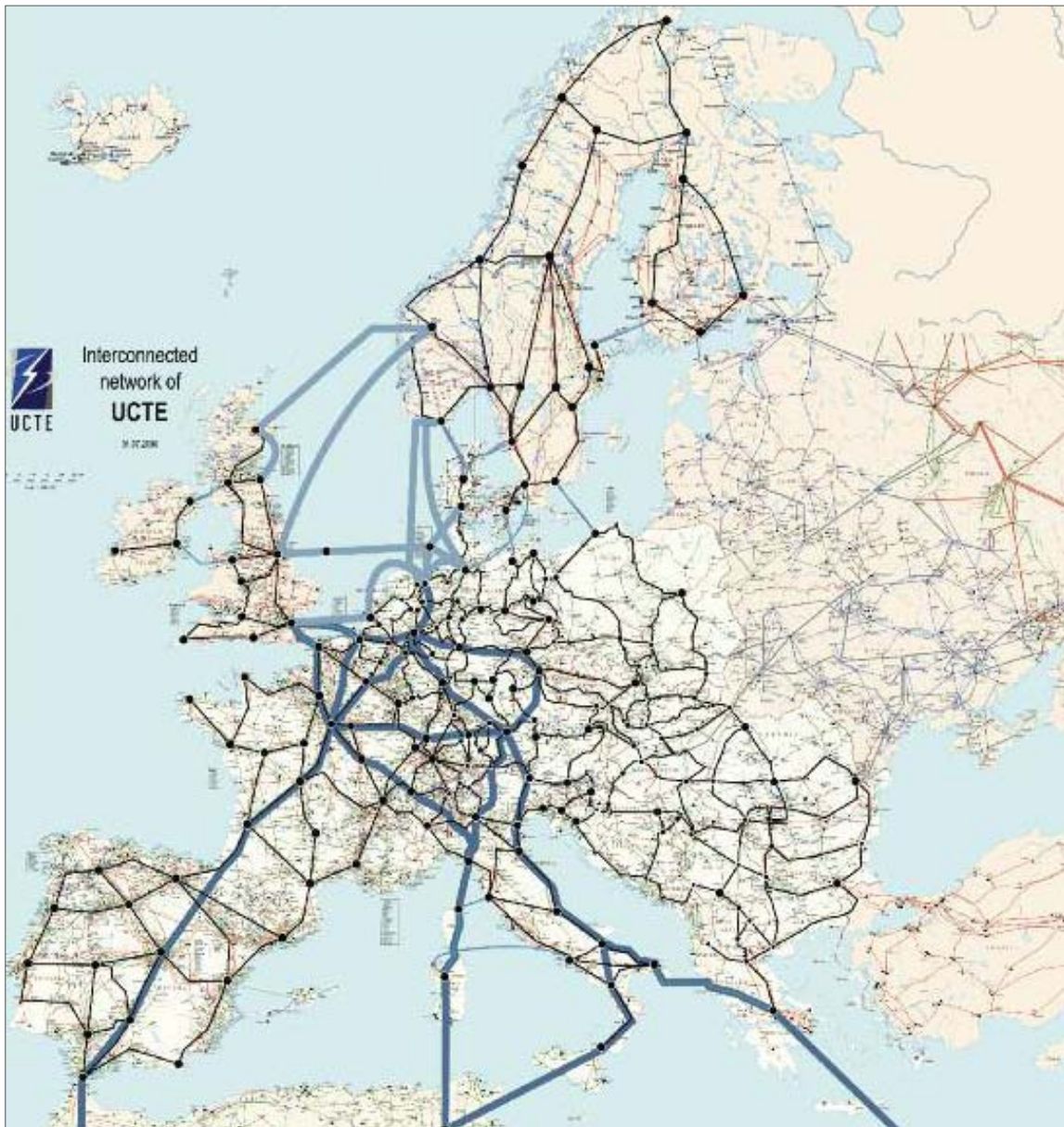
Abbildung 79 Struktur eines vorgeschlagenen „European Super-Grid“ zur Einbindung von solarthermischen Kraftwerken in Nordafrika und von Wasserkraftwerken in Skandinavien (Quelle: GREENPEACE / EREC (2009), S. 67)
