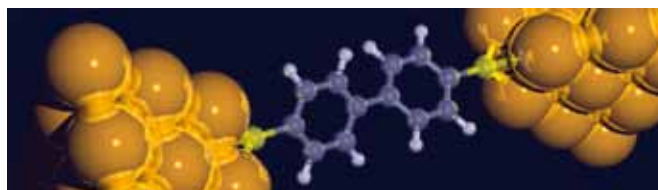
Ein Moleküldraht bestehend aus dem Einzelmolekül Biphenyl-dithiol (BPD) zwischen zwei Goldelektroden. Quelle: SCC
