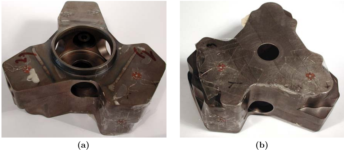
Abbildung 3.10: (a) Obere und seitliche Messstellen mit aufgeklebten Rosetten-DMS und (b) Unterseite des Pumpengehäuses mit zwei weiteren Messpunkten.
