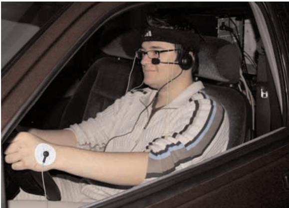
Im Fahrsimulator steuert ein Proband durch eine virtuelle Fahrstrecke und kommuniziert mit einem interaktiven Dialogsystem, während mittels verschiedener Biosignale sein emotionaler und kognitiver Zustand ermittelt wird.
