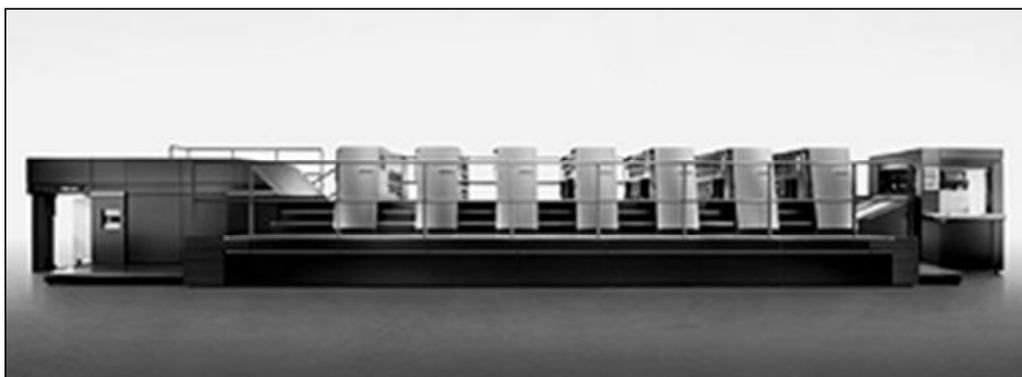
*Bild 2-1: Bogenoffsetmaschine (Quelle [Heid-09b])*
