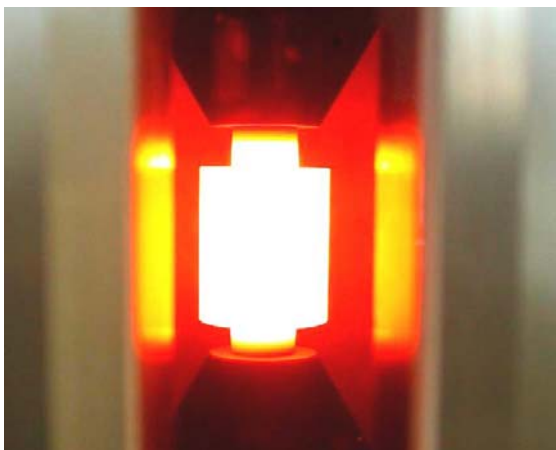
Abbildung 3-4 FAST-Werkzeug im Prozess bei ca. 1100 °C
