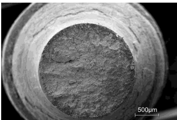
Abbildung 7-46 Bruchfläche 18Ni350 + 10 Vol. % ZrO_2
