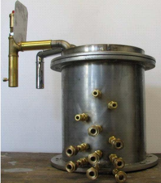
**Abbildung 3.10:** Brennkammer mit Stutzen zur Aufnahme der Thermoelemente
