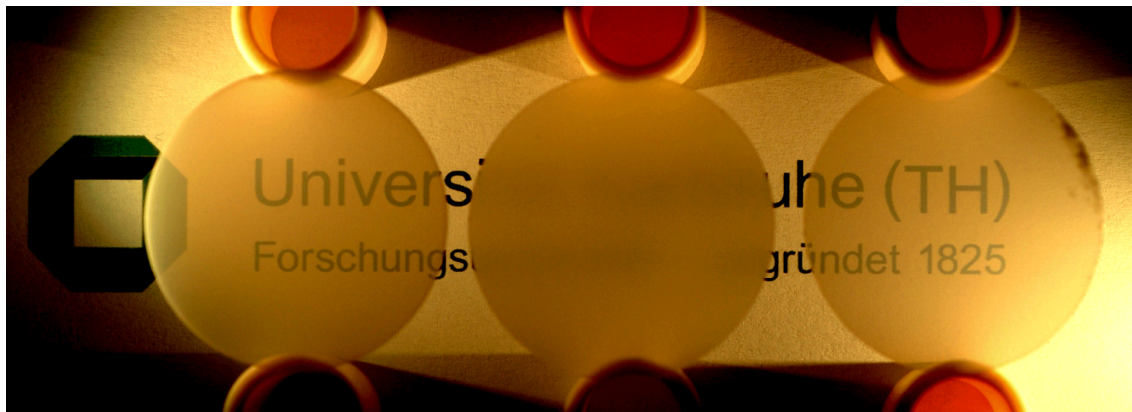
Abb. 5.2: Al 2 O 3 Proben mit 25 mm Abstand zur bedruckten Unterlage.
