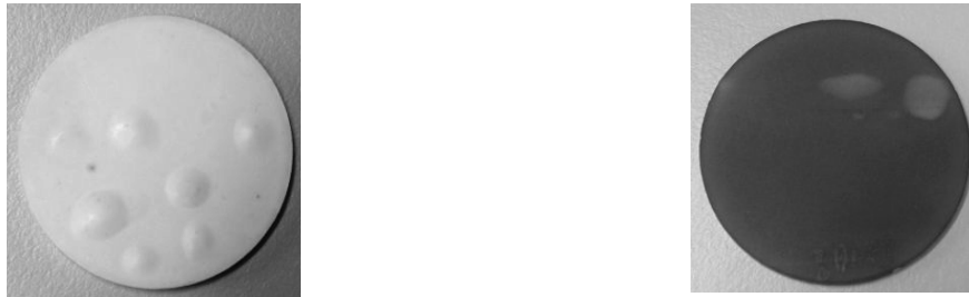
a) Mg–Spinell nach HIP an Luft geglüht, 1500 °C / 12 h b) Mg–Spinell nach HIP an Luft geglüht, 1350 °C / 24 h
