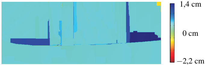
(c) Abweichung der Tiefenbestimmung aus Bild 5.6(c) zur Referenz.
