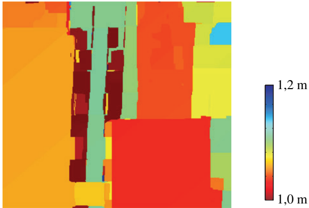
(a) Durch reine Stereofusion erhaltene Tiefenkarte (mit fehlerhaft bestimmter Tiefe im Hintergrund);
