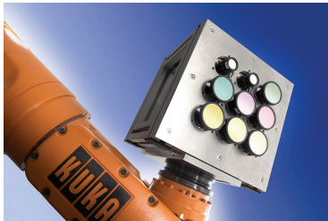
(a) Das verwendete Kamera-Array in Kombination mit einem Industrieroboter;
