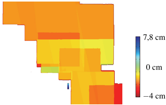
(a) Abweichung der Tiefenbestimmung aus Bild 5.22(a) zur Referenz;
