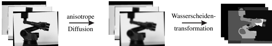
Bild 1.2: Beispiel zur Vorverarbeitung für eine flächenbasierte Fusion zur Tiefenbestimmung nach Kapitel 4.
