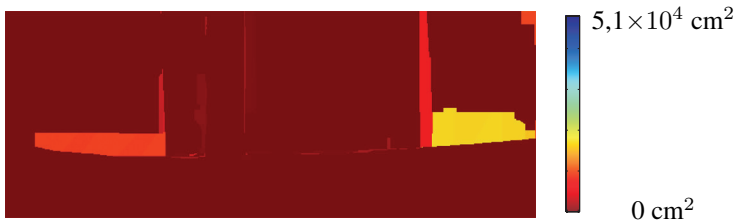
(c) Quadratische Abweichung der Tiefenbestimmung aus Bild 5.6(c) zur Referenz.
