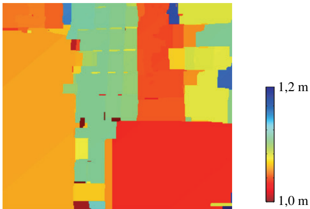
(b) Durch Fusion von Stereo- und Defokusinformation erhaltene Tiefenkarte.
