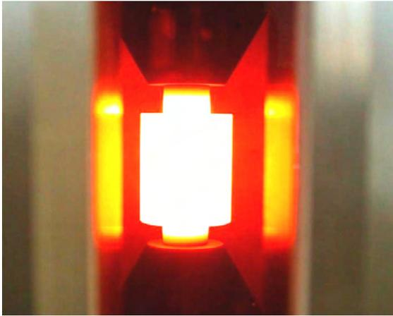
Abbildung 3-4 FAST-Werkzeug im Prozess bei ca. 1100 °C
