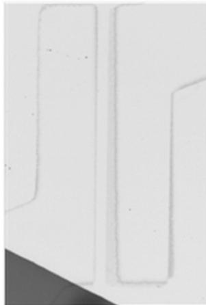
Abbildung 4.32: Invertiertes Lichtmikroskopbild von zwei benachbarten Fotodetektoren mit Zuleitungen. Abstand ca. 140  $\mu\text{m}$ , Außenmaße ca. 450  $\mu\text{m}$  x 2 mm.
