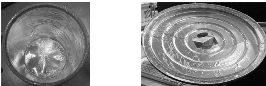
Bild 7.1: Abschirmung des Versuchsaufbaus mit Kupferfolie
