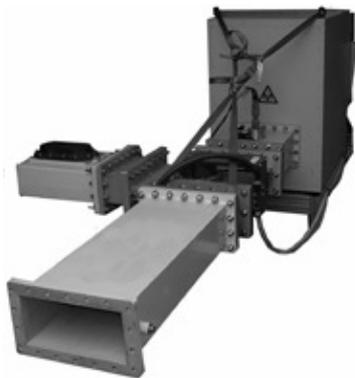
(c) 915 MHz Magnetron mit Zirkonlast
