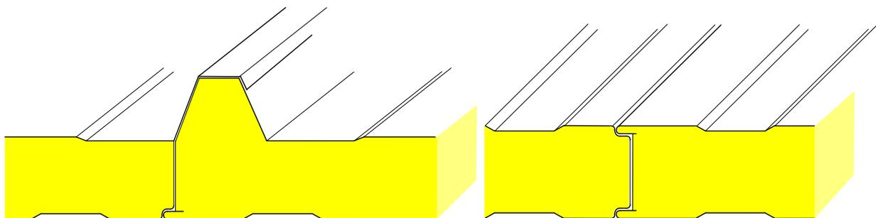
**Fig. 2.2: Longitudinal joints**
