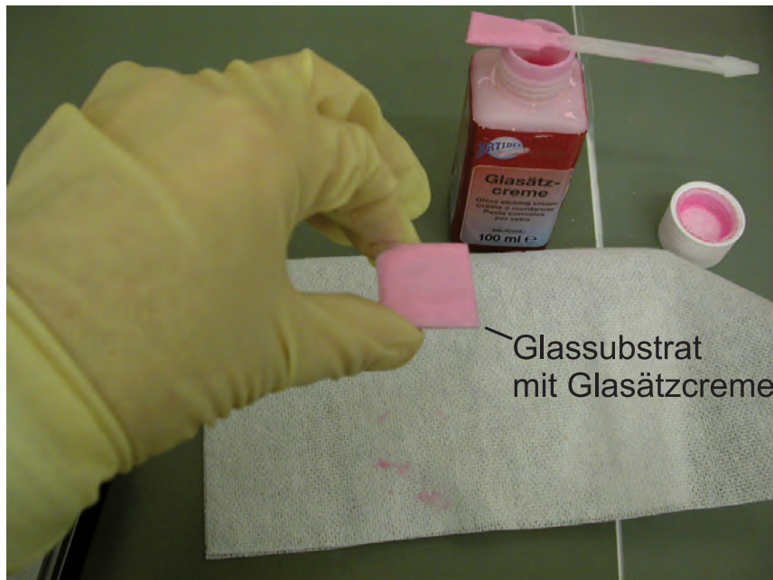
Abbildung A.6: Die Glasätzcreme wird mittels Spatel flächig auf das Glassubstrat aufgebracht. Nach einigen Sekunden Einwirkdauer wird sie mit Wasser abgespült [161].
