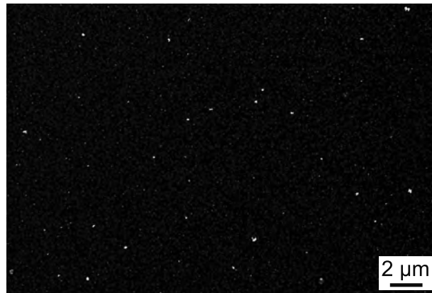
Abbildung 6.2: REM-Aufnahme der Oberfläche einer Super Yellow-Schicht, auf die eine Nanopartikel-Dispersion aufgetragen ist. Es zeigt sich, dass sich die Nanopartikel zu größeren Clustern (helle Punkte) auf der Oberfläche der Emitterschicht zusammenfinden.
