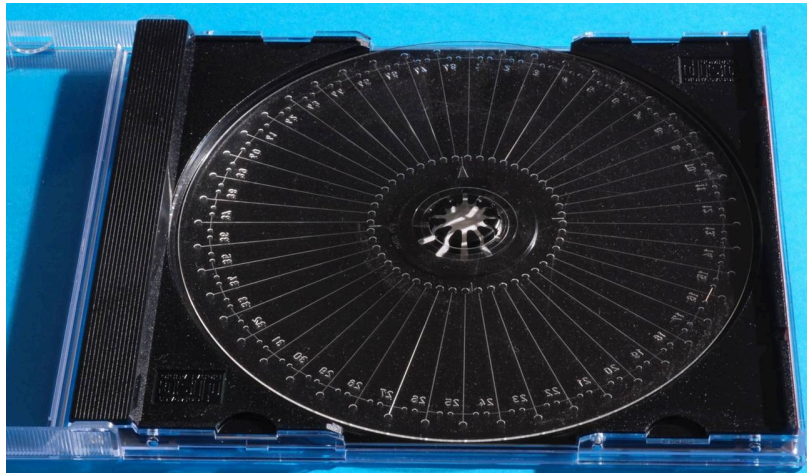
Abbildung 5-7 abgeformte CE-Disc aus COP in einem CD-Gehäuse
