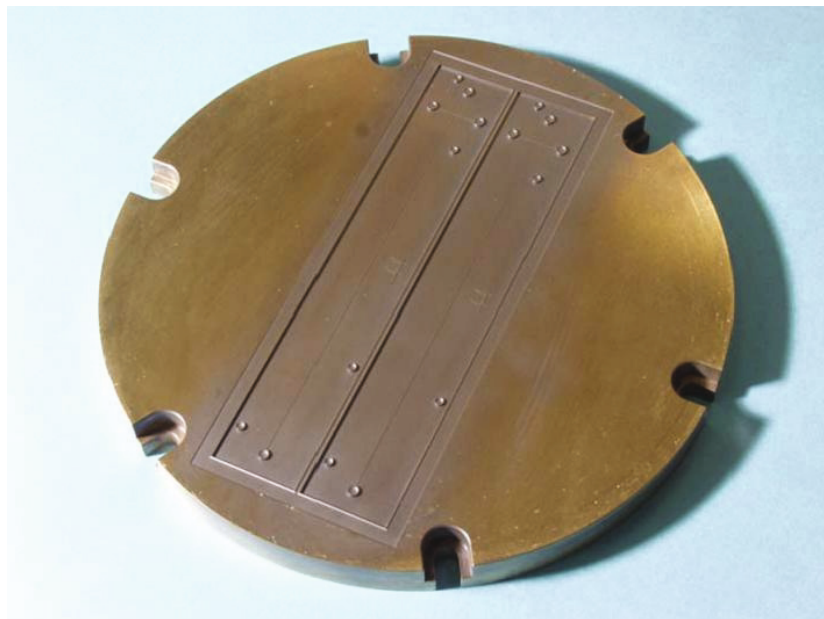
Abbildung 3-2 Formeinsatz aus Messing mit zwei CE-Strukturen [65]
