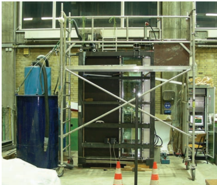
Bild 5.6: Versuchsstand mit Messtechnik, Vorratssilo und Einrieselvorrichtung
