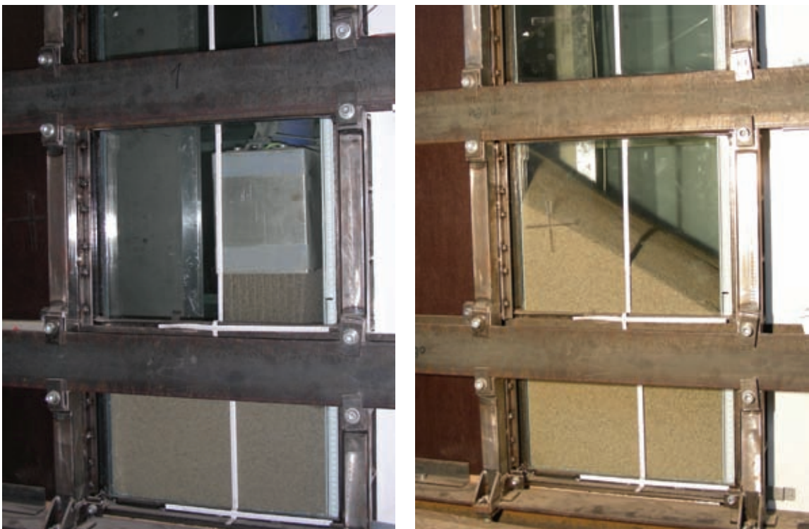
Bild 5.15: Einbauvorgang Karlsruher Sand; dichter Einbau mit Rieselkasten (rechts), lockerer Einbau mit Schütttrichter – Position des Wagens im linken drittel (links)
