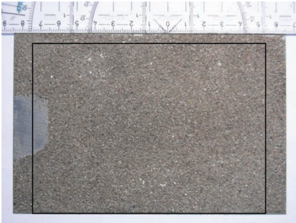
Bild C.55: Sand-beschichtete Platte mit Maßstab am Rand als Führung, und PIV-Ausschnitt
