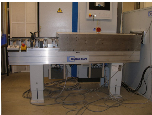
(a) Filter mit Einlaufrollenbahn auf der linken Seite. Hierüber wird das Parkett zugeführt.
