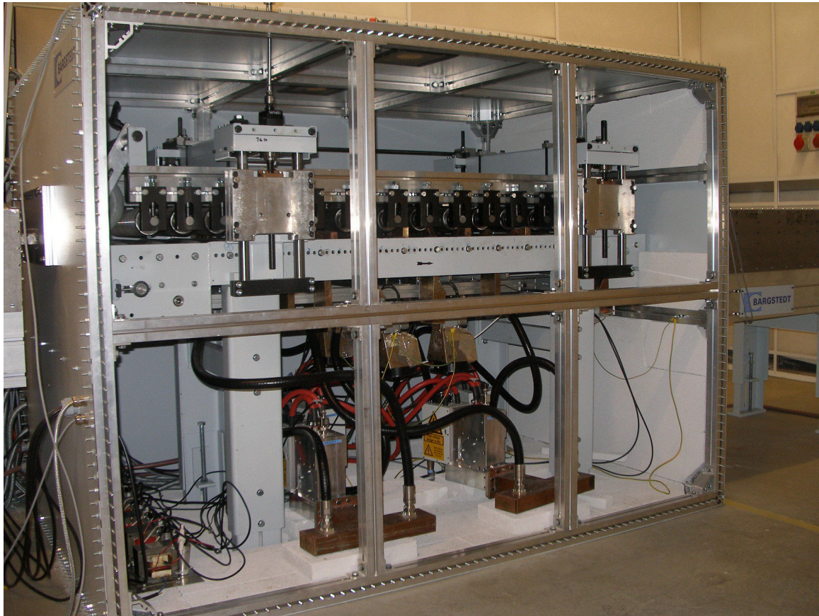
Bild 6.1.: Kernstück der mikrowellenunterstützten Parkettpresse. Zu sehen sind die Rollenpresse mit Ober- und Unterdruckrollen, die Mikrowellenantennen zwischen den Unterdruckrollen sowie die Mikrowellengeneratoren und das Verteilnetzwerk im unteren Bereich. Das Parkett durchläuft die Presse von links nach rechts. Auf der rechten Seite ist ein Teil des Auslauffilters mit dargestellt.
