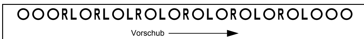
Bild 6.8.: Schematische Anordnung der 13 Antennen zwischen den insgesamt 15 Rollen. Die Bezeichnungen L bzw. R beziehen sich auf Einspeisung von der linken bzw. rechten Seite, jeweils in Richtung des Vorschubes betrachtet. Vergleiche auch Bild 6.7b.
