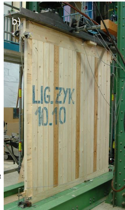
Bild 4-16 a) Skizze Wandscheibenprüfkörper aus Fux4S-Elementen, b) Wandscheibe in Prüfapparatur
