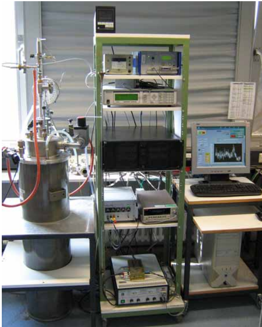
Abbildung 3.2: Messplatz mit Kryostat (links), Messinstrumente (Mitte) und Arbeitsplatz (rechts)
