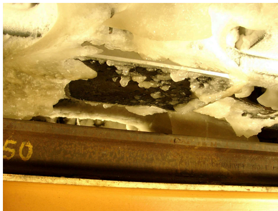
Bild 2.4: Vereiste Außeneinheit nach Erprobungsfahrten in Schweden.
