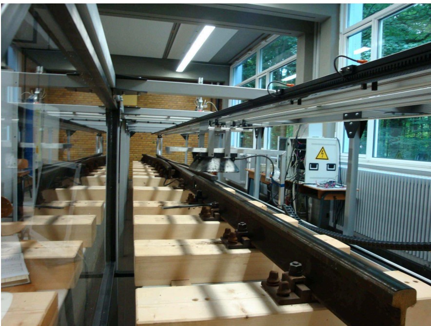
Bild 2.9: Ansicht des Laboraufbaus am MRT mit installiertem Wirbelstromsensor und befahrbarem Weichenbauteil.
