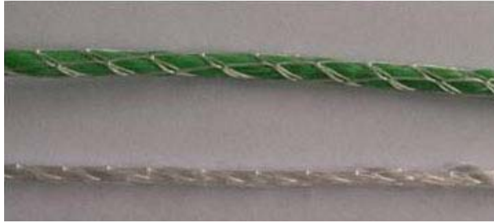
Abbildung 4.16: Kemafileiertes Kernmaterial, PP3x600 tex (weiß) und Spleißfolie 4500 tex (grün) [114]
