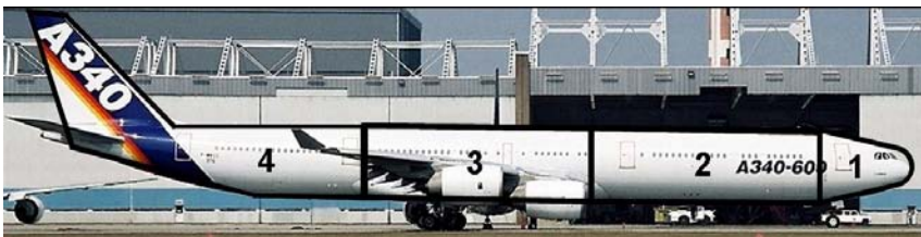
Abbildung 3.13: Airbus A340-600, unterteilt in die vier Abschnitte: Cockpit, Kabine, Kabine im Bereich der Tragflächen und Heck des Flugzeugs
