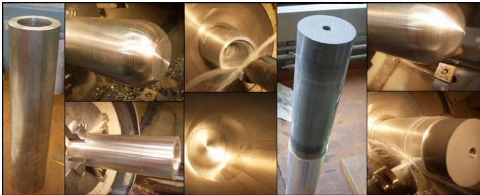
Abbildung 3.20: Einzelschritte der Fertigung des vorderen Projektelteils
