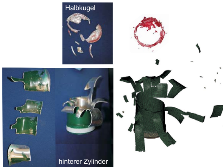
Abbildung 8.13: Vergleich der Fragmente aus Experiment und numerischer Berechnung für Versuch K18
