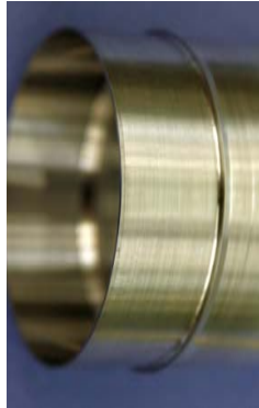
Abbildung 3.16: Teilweise außenliegende Steife für Projekttilvariante K2
