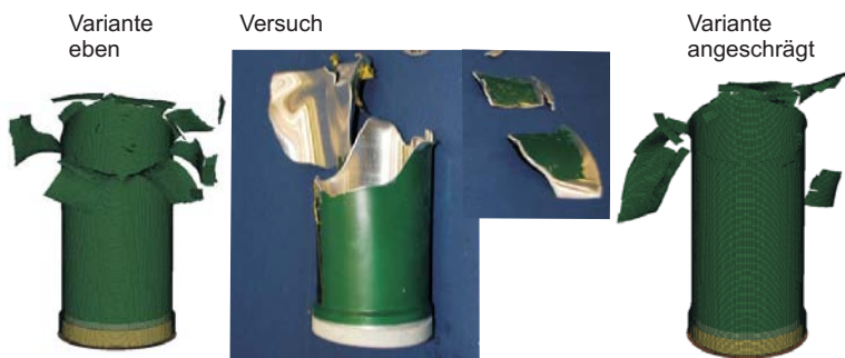
Abbildung 8.19: Vergleich der Reststücke des hinteren Projektileils aus Versuch und numerischer Berechnung für Versuch K14
