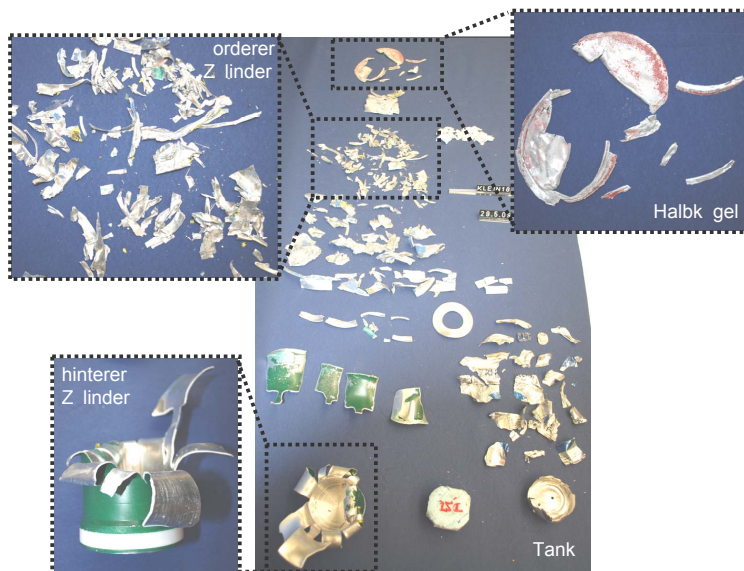
Abbildung 5.17: Fragmente nach dem Aufprall, Versuch K18
