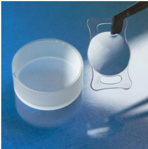
Abb. 36: Glasgehäuse mit Deckel und kommerzielle, implantierbare Intraokular-Linse zum Größenvergleich.
