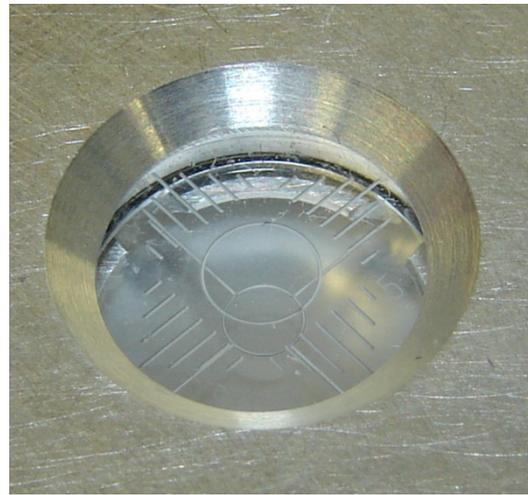
Abb. 37: PMMA-Dummy zur Testimplantation mit Laser-Markierungen auf Vorder- und Rückseite (in einer Transport-Halterung).
