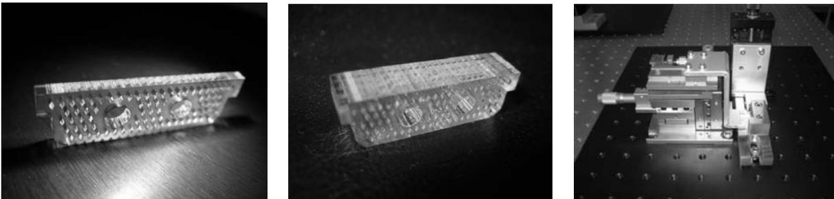
Abb. 26: Konzept zur Herstellung großflächiger Spiegel aus Einzelelementen großer Strukturhöhe (Links: einzelne Spiegelstruktur, Mitte: vierfach gestapelte Spiegelstruktur, Rechts: Stapelvorrichtung)
