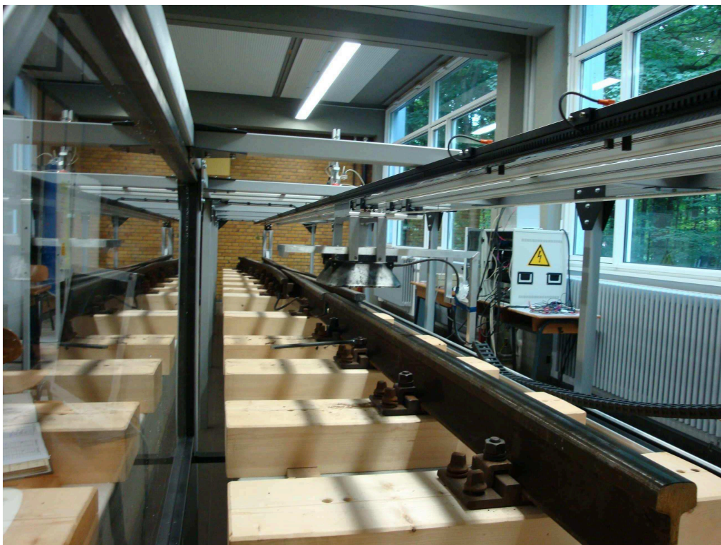
Bild 2.9: Ansicht des Laboraufbaus am MRT mit installiertem Wirbelstromsensor und überfahrbarem Weichenbauteil.
