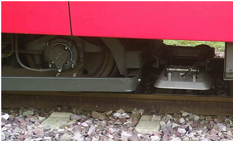
Bild 2.3: Außeneinheit befestigt am Drehgestell einer Straßenbahn.
