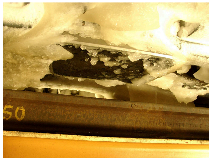
Bild 2.4: Vereiste Außeneinheit nach Erprobungsfahrten in Schweden.
