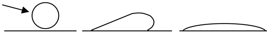
Abb. 2.22: Schematische Darstellung des sich auf der Zielflüssigkeitsoberfläche ausbreitenden Tropfens in seitlicher Perspektive.
